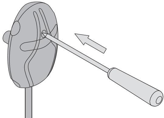
**Рисунок 11. Кнопка сброса защиты от перегрева**
